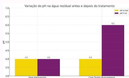
Figura 3. Gráfico de variação de pH antes e depois do tratamento com a planta. Fonte: Imagem autoral.
